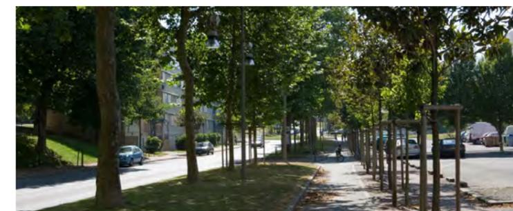
La rue des frères Lumières est structurée par un double alignement d'arbres de haut jet. La chaussée est réduite à 6m. Lorsque possible, les limites de propriétés ou les grandes surfaces d'enrobé pourront être découpées d'une noue plantée. Un piétonnier est installé côté Ouest de l'avenue où le trafic de poids lourd est le moins important.
